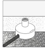
Posizionare la cassaforma con la parte superiore a filo parete o pavimento. Applicare il tappo in dotazione per evitare che corpi estranei entrino all'interno. Prevedere un adeguato drenaggio sotto la cassaforma.
