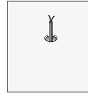
Controllare che la cassaforma non si muova durante la posa del massetto. Effettuare il passaggio del cavo elettrico dalla cassaforma al pozzetto. Richiudere la cassaforma con il tappo in dotazione.
