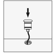
Dopo la rasatura rimuovere il tappo ed eseguire il collegamento elettrico come previsto dalla scheda del prodotto, verificarne il corretto funzionamento ed inserirlo nella cassaforma con una leggera pressione.
